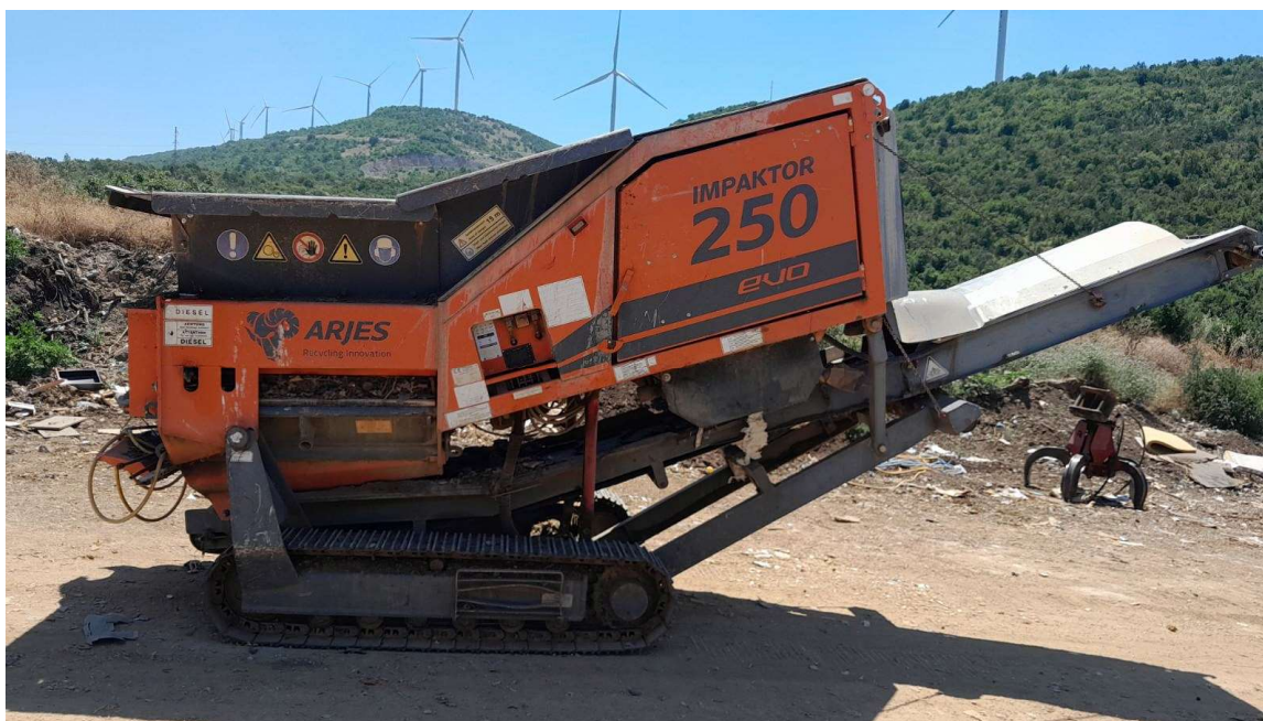
Slika 8. Drobilica za kabasti otpad Arjes Impaktor 250
