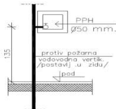
Slika 17. Hidrant na zidu
