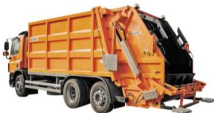
Specijalno vozilo Autosmečar sa potisnom pločom za kontejnere 1,1m 3
