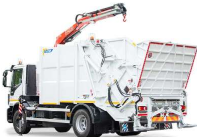
Vozilo za odvoz otpada sa dizalicom za polupodzemne kontejnere 3 -5m 3 i kontejnere 1,1m 3
