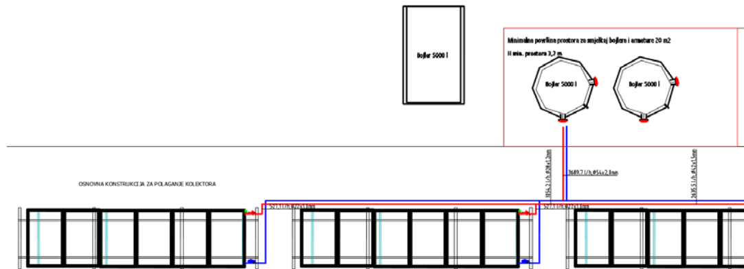
Slika br.3.9-Šema solarnih kolektora i bojlera
