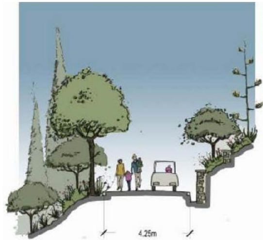
Primjer uređenja prilaznih saobraćajnica sa ozelenjavanjem usjeka i nasipa
